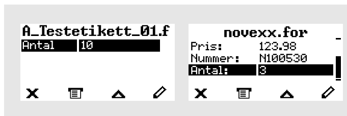
Figur 48: Filvalg i standalone-drift (til venstre: standardfelt til forespørgsel af mængde; til højre: forespørgsel af andre data)
