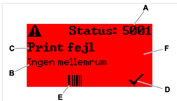
Figur 53: Eksempel på visningen af statusmeldinger
