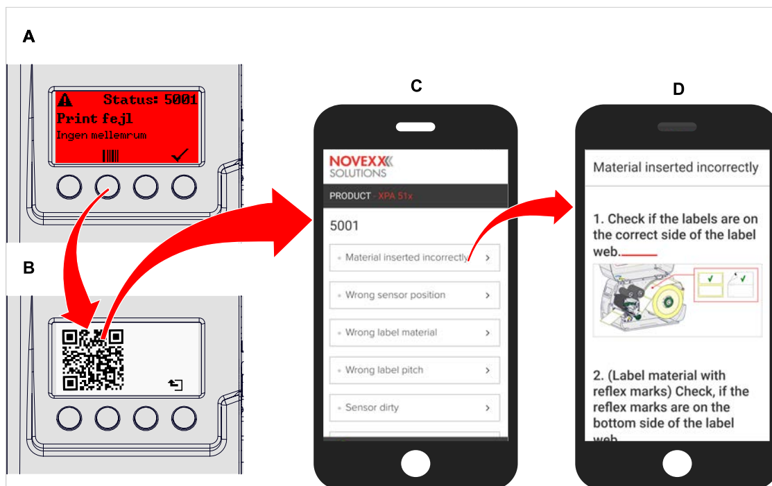
Figur 58: Har fejlmeldingen en strejkode (A), kan der downloades en vejledning til afhjælpning af fejl (C) ved hjælp af QR-koden (B).
