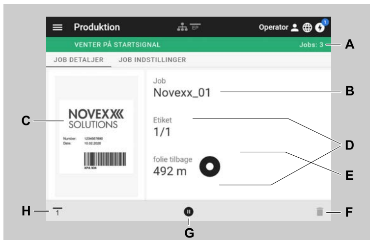
Figur 20: Visning "Job detaljer" for et udskrftsjob i webpanel.
