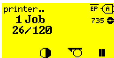
Figur 56: Folieadvarsel under et printjob: Baggrunden er gul, foliesymbolet blinker.
