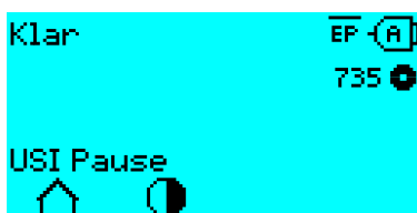
Figur 57: Eksempel: USI-statusmelding "USI Pause".
